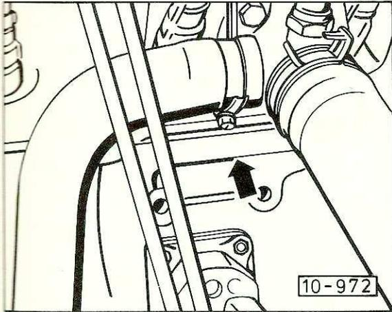
Le numéro de moteur est frappé au-dessus du régulateur de réchauffement sur le côté gauche du bloc-cylindres.
