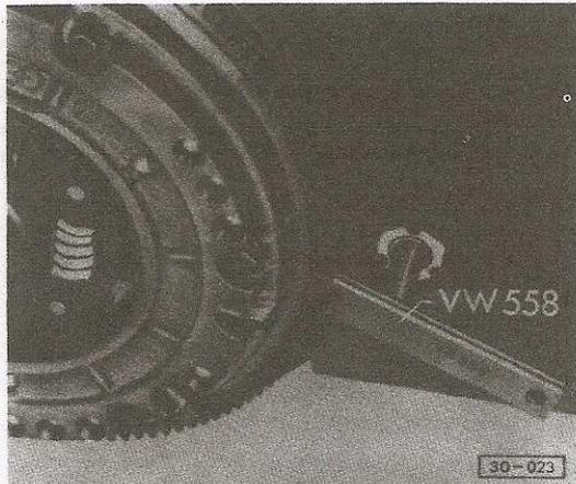
Fig. 1 Volant-moteur : dépose et repose
