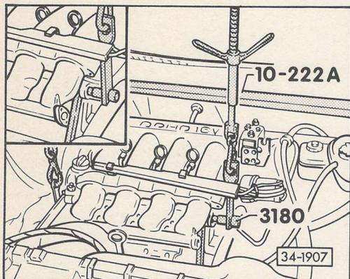
L'outil spécial 3180 est offert avec effet immédiat pour permettre l'utilisation du dispositif de soutien 10-222 A lors de la dépose et de la repose de la boîte de vitesses.
